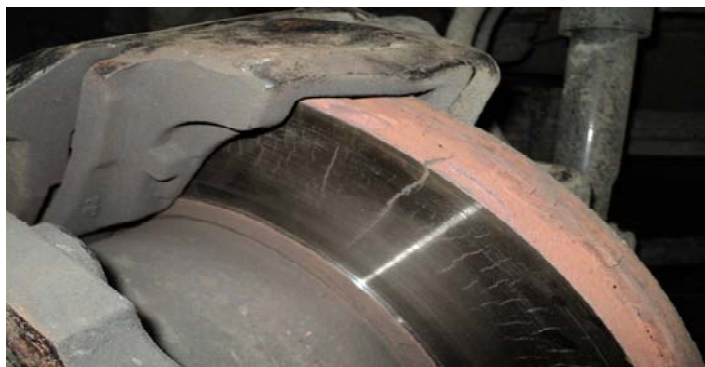
Рис. 5. Вид изложенного тормозного диска в автомаш. MAN-TAG
