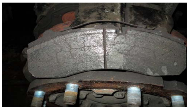
Рис. 6. Вид изношенных тормозных колодок в автомаш. MAN-TAG
