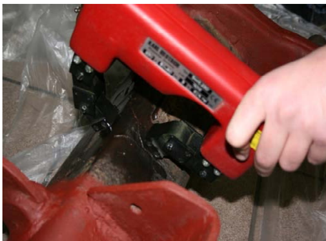
Рис. 19. Вид оси полуприцепа во время магнитного испытания
