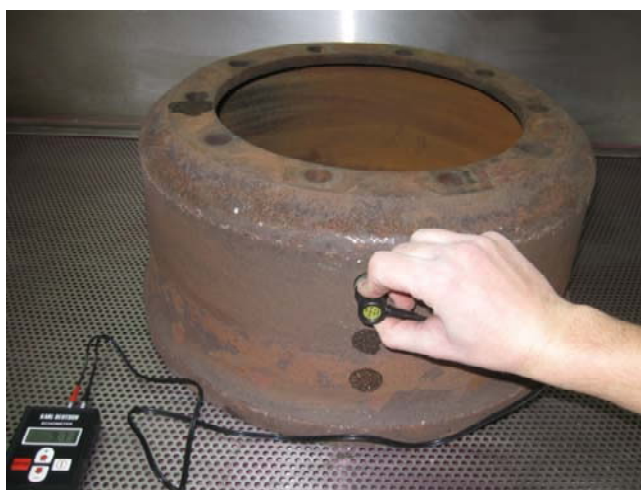
Рис. 13. Измерение толщины стенки тормозного барабана
