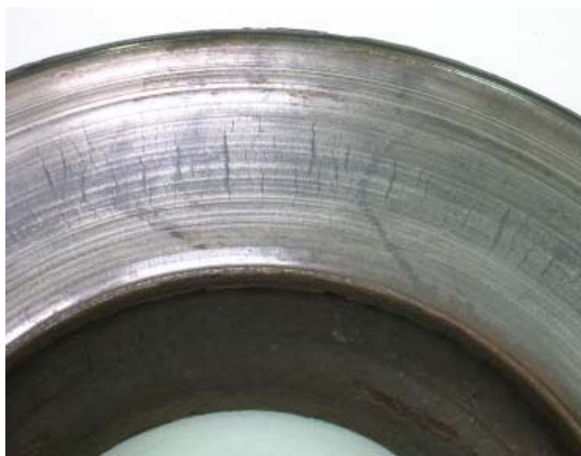
Рис. 7. Вид изношенного диска тормоза с видимыми трещинами и подозрением в наличии микротрещин
