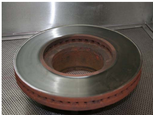
Рис.14. Вид изношенного тормозного диска предназначенного для NDT испытаний (трещины/микротрещины/толщина)
