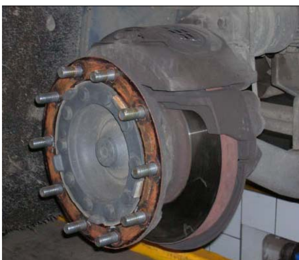
Рис. 4. Вид дискового тормоза предназначенного для не разрушаемого контроля
