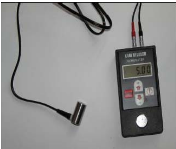
Рис. 11. Вид ультразвукового прибора для измерения толщины деталей
