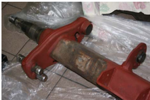
Рис. 15. Вид оси полуприцепа BPW с подозрением на наличие трещины
