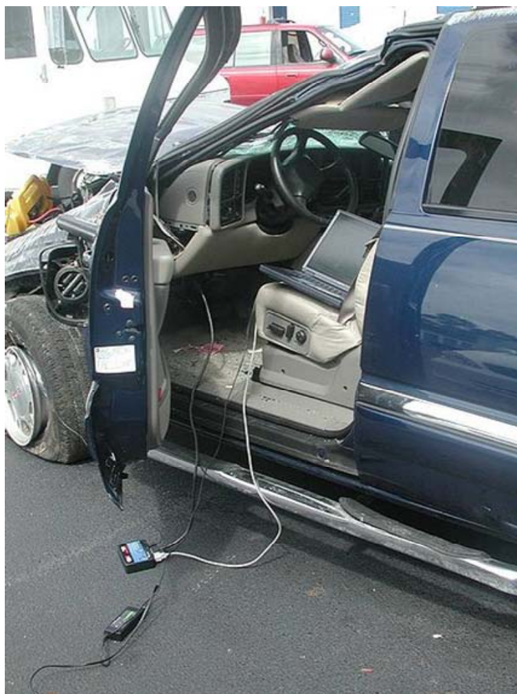
Рис. 1. Получение данных с General Motors Sensing and Diagnostic Module (SDM) через разъем Diagnostic Link Connector используя оборудование Vetronix Crash Data Retrieval system
