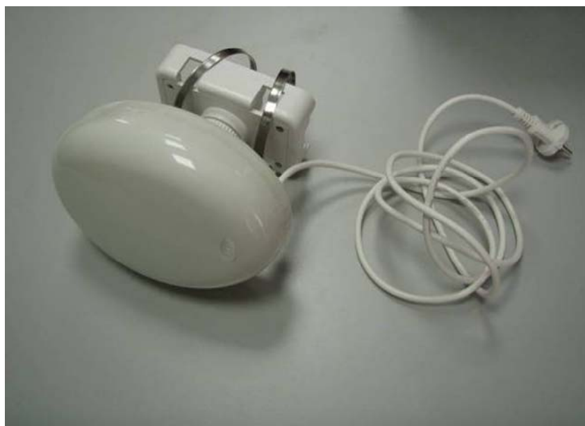
Рис. 2. Имитатор излучения систем автоматической видеофиксации
