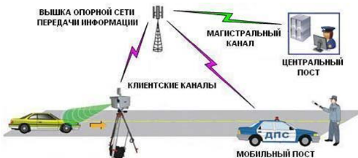
Рис. 3. Схема работы стационарного модуля идентификации
