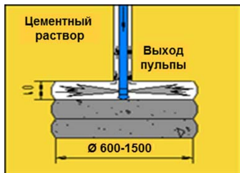
Рис. 1. Закрепление слабых грунтов методом струйной цементации - подача цементного раствора
