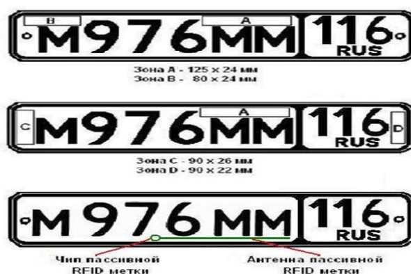
Рис. 1. Зоны размещения RFID-метки на номерного знака
